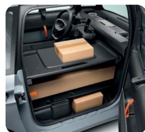
Sostituzione del sedile del passeggero con un box modulare e protetto. La parete divisoria verticale delimita l'area di guida dall'area di carico.
